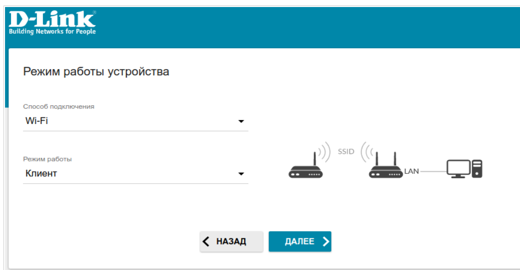
Рисунок 27. Выбор режима работы устройства. Режим Клиент .
