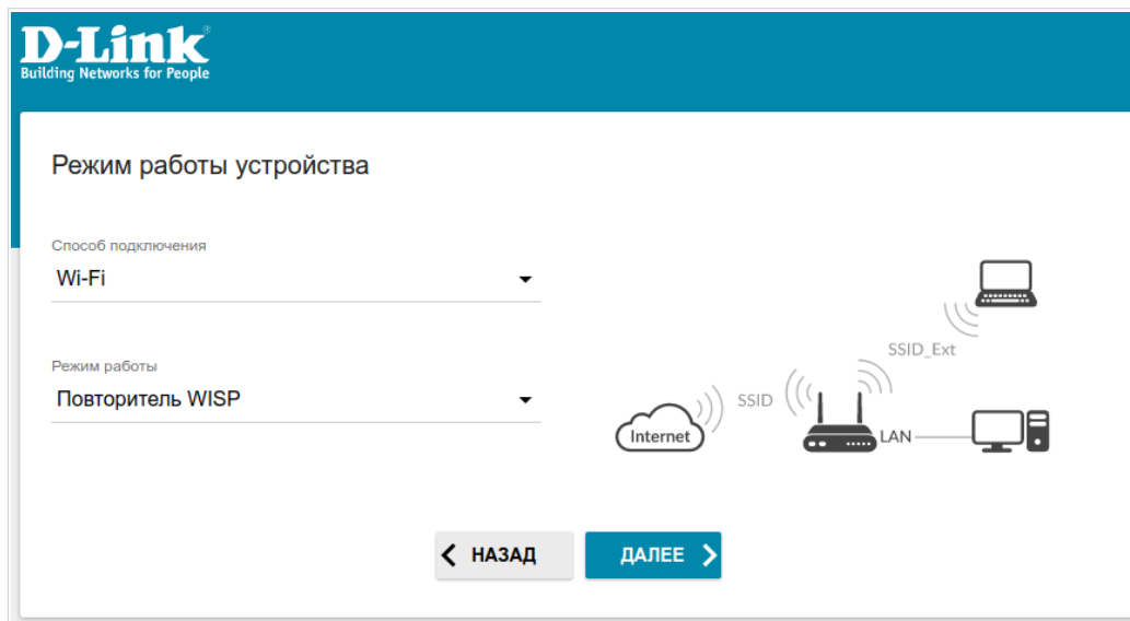
Рисунок 24. Выбор режима работы устройства. Режим Повторитель WISP .
